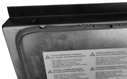
Fig. 21 - Guarnizione deteriorata
